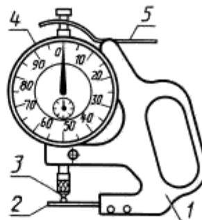
1 — корпус; 2 — неподвижный стержень; 3 — измерительный наконечник; 4 — отсчетное устройство; 5 — арретир
